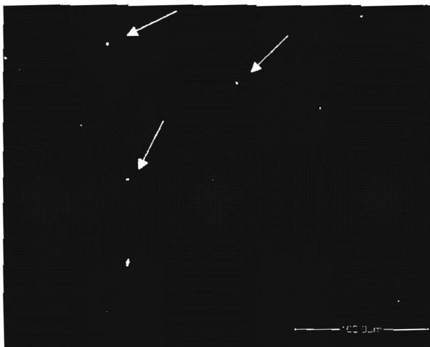
Fig. 8a Immagine ESEM dei detriti di 0.5 micron contenenti Carbonio (C), Ossigeno (O), Antimonio (Sb), Fosforo (P), Cobalto (Co) nel preparato di cellule staminali. (Area n.3 della tabella 3)
